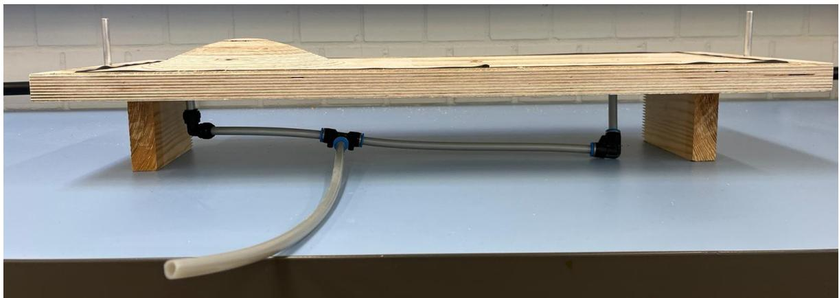
Abbildung 37: Vakuumform Platte mit Vakuumschlüssen, eigene Darstellung
