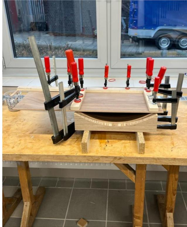
Abbildung 43: verleimen des Fertigteils, eigene Darstellung
