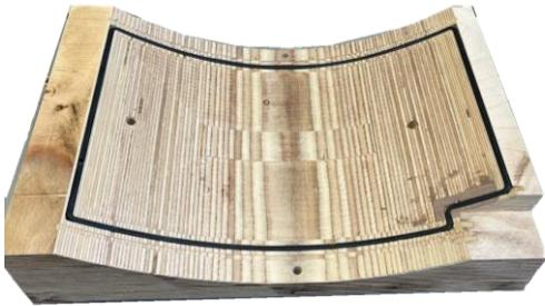
Abbildung 36: Vakuumform Bogen, eigene Darstellung
