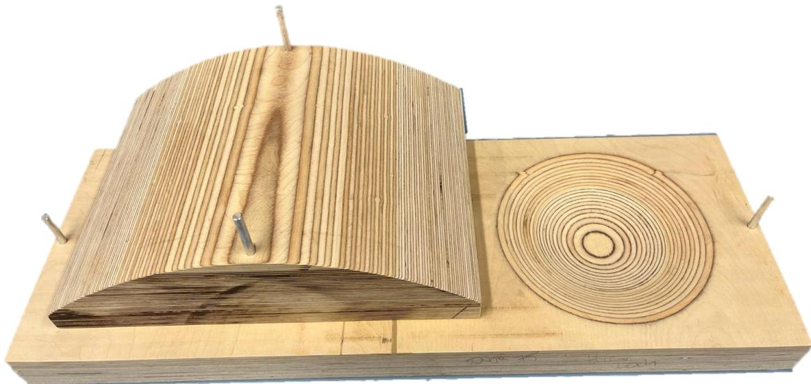
Abbildung 30: Pressformen Bogen und Platte, eigene Darstellung
