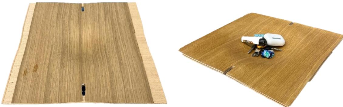
*Abbildung 28: Probe mit 3D-Deckfurnier, eigene Darstellung*
