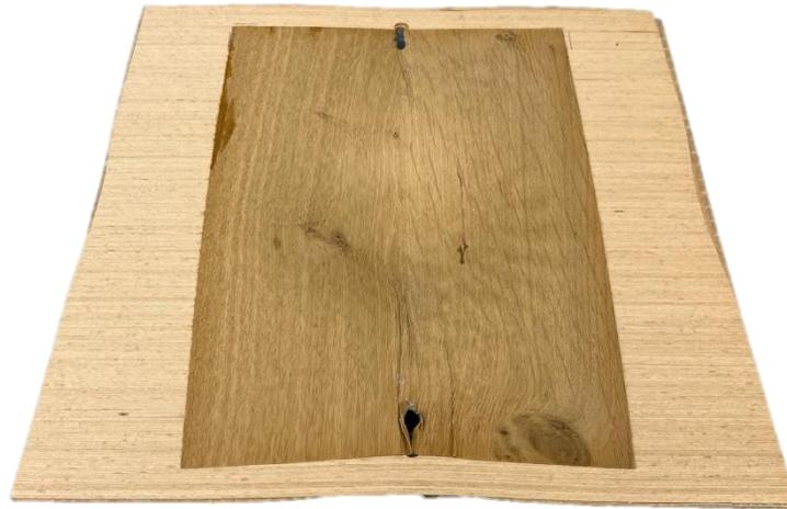
*Abbildung 26: Probe mit kaschiertem Furnier, eigene Darstellung*
