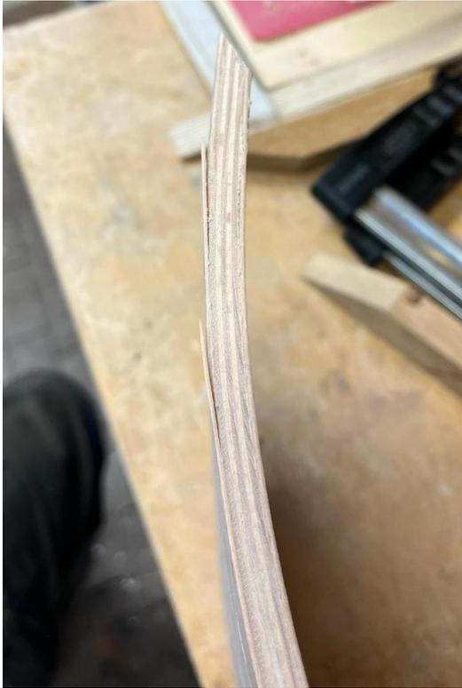
Abbildung 44: Ausrisse im Deckfurnier, eigene Darstellung
