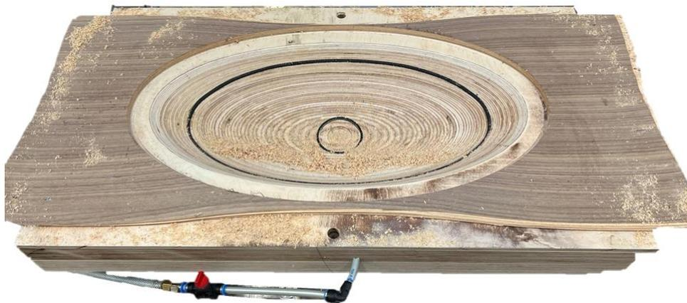
Abbildung 38: Formatierungsform mit Resten des Rohteils, eigene Darstellung
