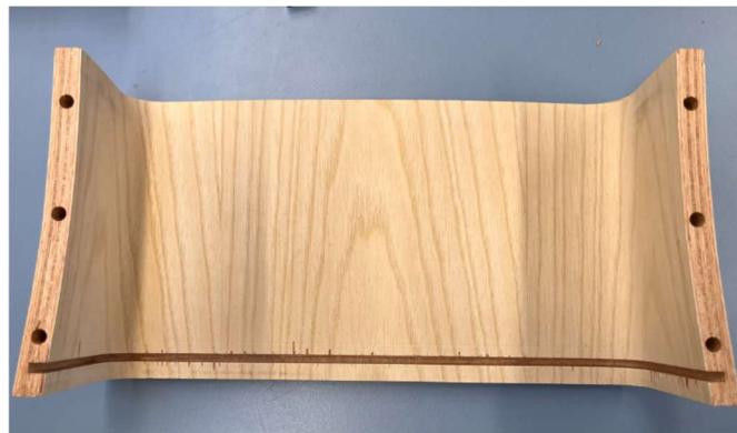
Abbildung 15: Nut zur Befestigung der Lautsprecherplatte
