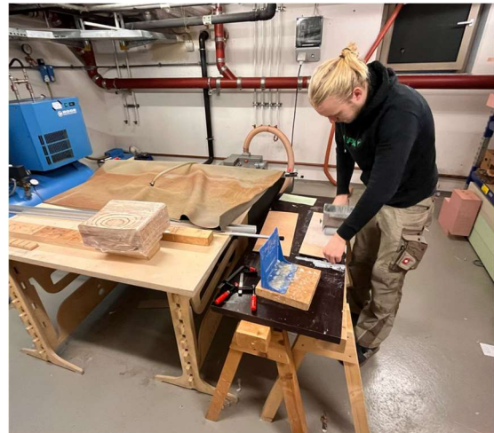
Abbildung 6: Verleimung mit Vakuumsack
