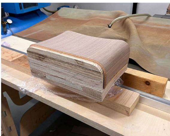
Abbildung 7: Formteil mit Pressform nach dem Pressvorgang
