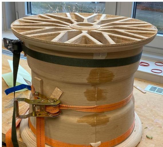
Abbildung 28: Verleimung der Formteile (Eigene Darstellung)
