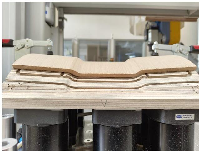
Abbildung 18: Luft unter der linken Rundung (Eigene Darstellung)
