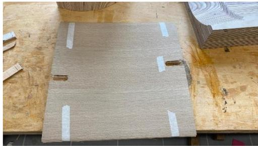
Abbildung 19: Aussparung für die Dübel (Eigene Darstellung)
