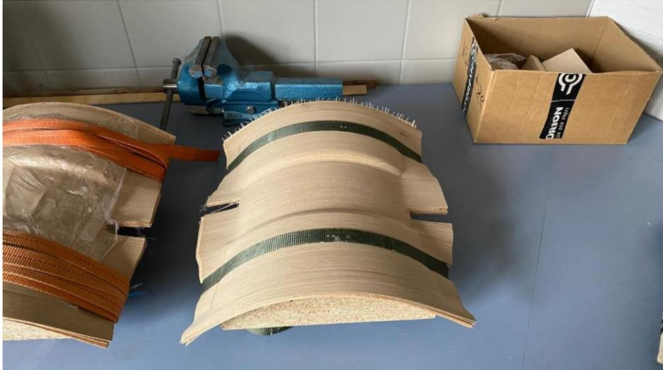
*Abbildung 23: Konditionierung der Formteile (Eigene Darstellung)*
