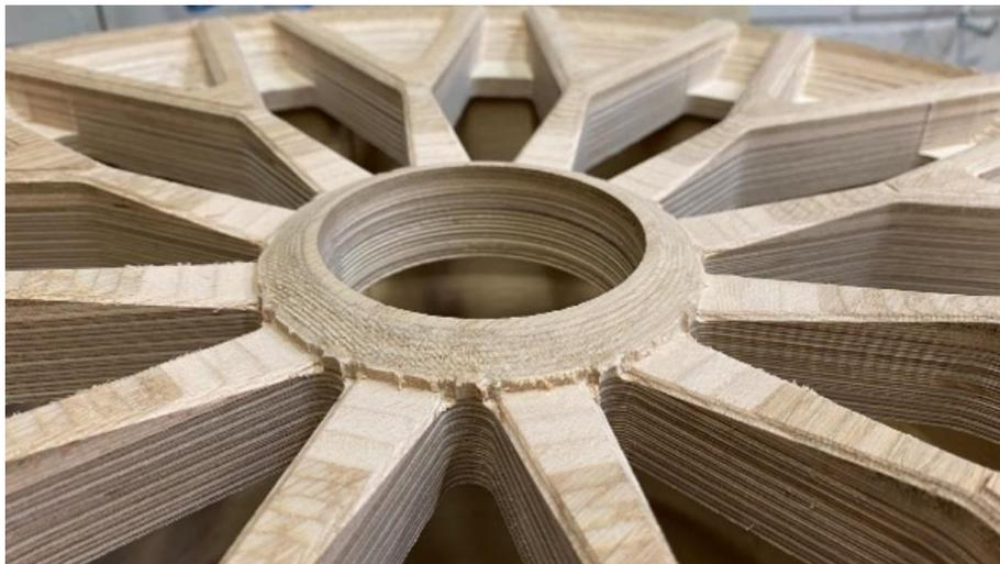
Abbildung 13: Kanten nach "Fräsen in Fräsrichtung" (Eigene Darstellung)
