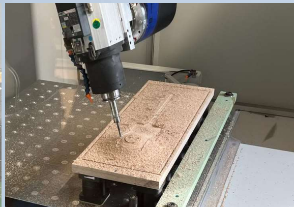
Bild links : Formatierung des Bogens in interpolärer Bearbeitung Bild rechts: Fräsen der Vakuumform der Platte in interpolärer Bearbeitung
