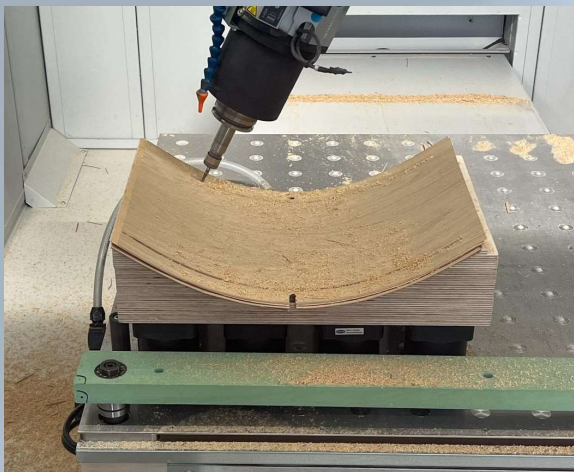
Bild links : Formatierung des Bogens in interpolärer Bearbeitung Bild rechts: Fräsen der Vakuumform der Platte in interpolärer Bearbeitung
