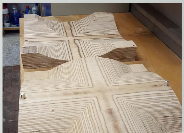
Bild links : 5-Achs-Fräsen der Außenkontur am fertig gepressten Kopfteil
