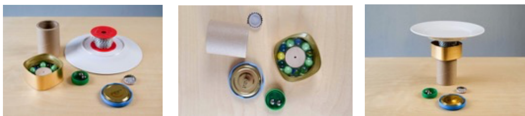
Abb. 17-19: Materialien und Experimente einfache Kugellager aus Alltagsgegenständen
